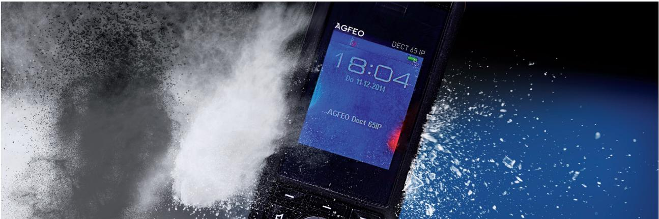
Die erste Ziffer (beim DECT 65 IP die 6) gibt den Schutzgrad gegen das Eindringen fester Fremdkörper einschließlich etwaiger Staubpartikel sowie den Berührungsschutz an. Sie weist auf die Staubdichtigkeit eines Betriebsmittels hin, das heißt, Staub darf nicht in das Gerät eindringen. Zudem muss der Schutz vor Berührung bei Zugang mit einem Draht – (stabförmige Messsonde mit einem Durchmesser > 1,0 mm) – gewährleistet sein.
