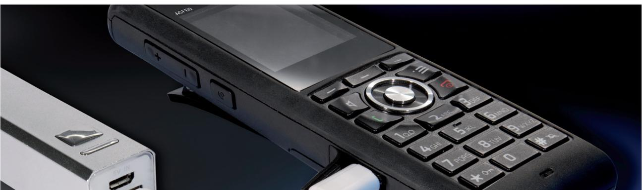
Der seitliche USB-Anschluss bietet für den Endanwender die hervorragende Möglichkeit, eine AGFEO PowerBank zum Verlängern der Betriebszeit bzw. zum Nachladen anzuschließen. Auch hier gilt der Ladetemperaturbereich von +5° C bis + 45° C.
